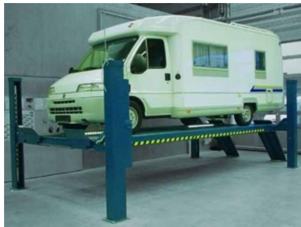
FIGURE 9 – Pont élévateur 4 colonnes 8 tonnes [2]
